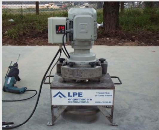
Figura 01 – Aparelho para avaliação da resistência superficial
