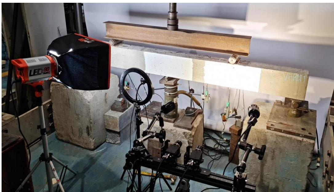
Figura 2 – Setup de ensaio utilizado para as vigas hiperestáticas
