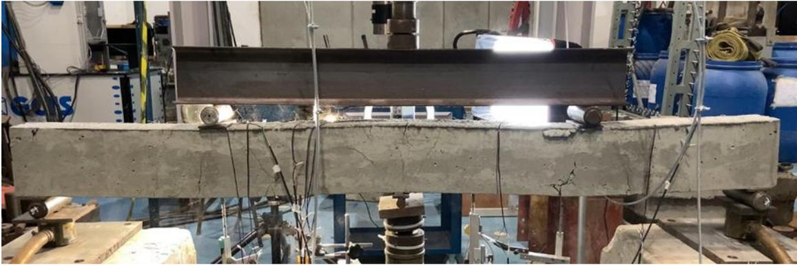
Figura 10 – Modo de falha da viga VH1F80
