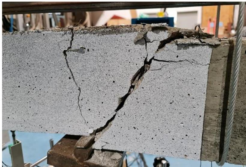
Figura 7 – Ruptura por cisalhamento da viga VH1F40
