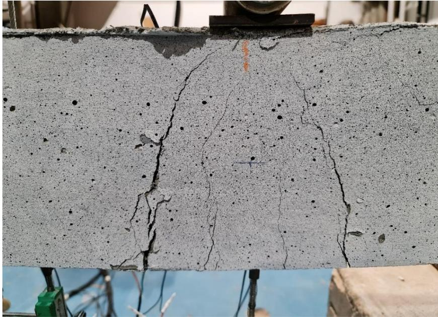
Figura 6 – Fissuras de flexão no centro de um dos vãos da viga VH1F40
