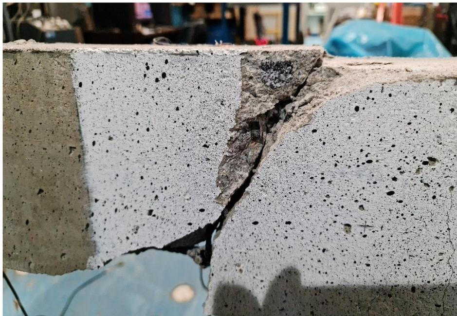
Figura 4 – Cisalhamento no centro de um dos vãos da viga VH1S
