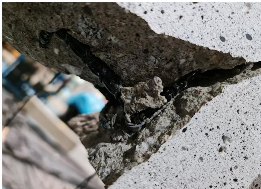
Figura 5 – Ruptura do estribo de GFRP na viga VH1S
