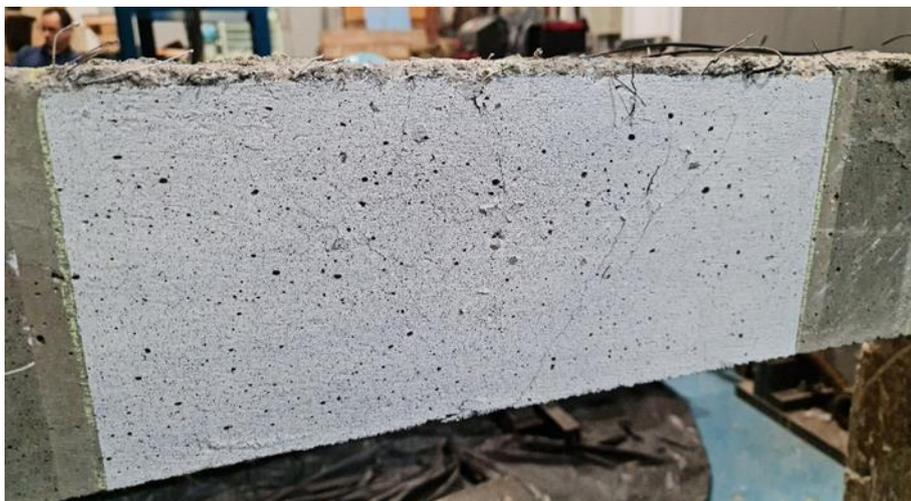
Figura 9 – Fissuração na região do apoio central da viga VH1F80
